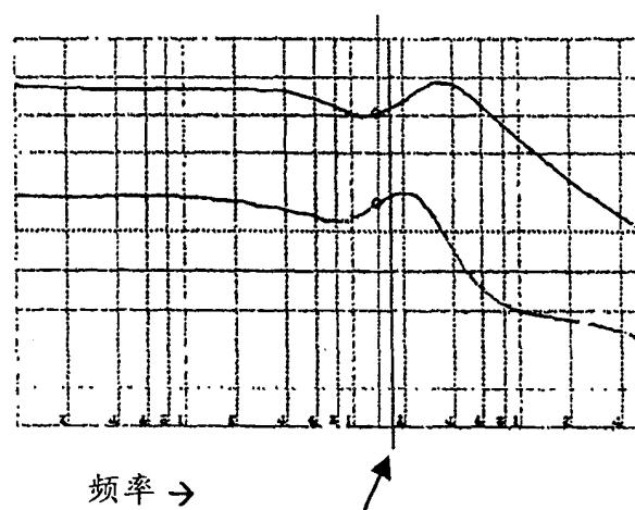
电感 116 和隔直流电容 100 形成的共振点 ≈ 1.7KHz
