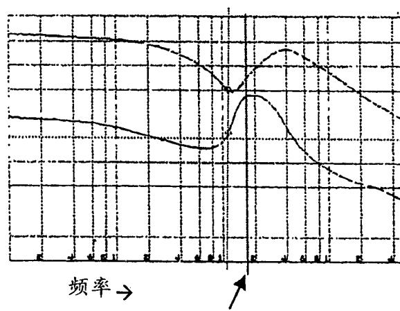
电感 116 和隔直流电容 100 形成的共振点  $\approx 1.7\text{KHz}$
