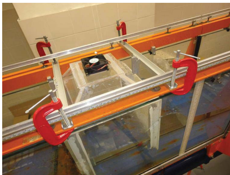
圖 5-8 震盪水柱模型模擬轉化海浪能為電力
