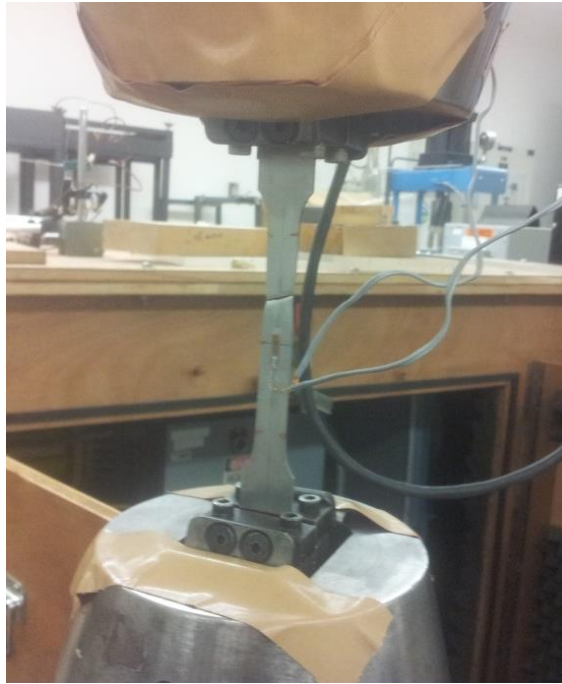
Fig. 1: Coupon test of stainless steel Type A (EN 1.4301)
